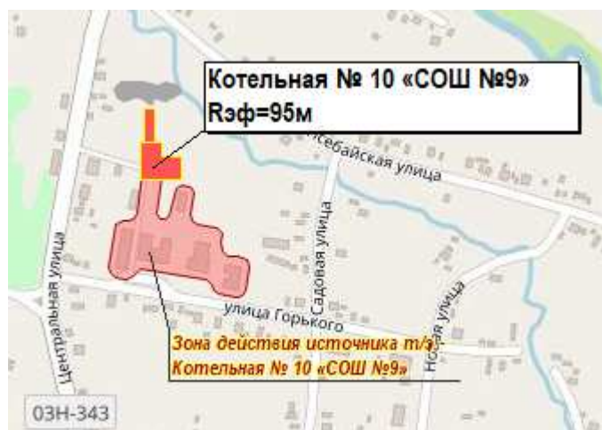
Рис. 2.12. Существующая зона действия системы теплоснабжения и источника тепловой энергии – котельной №10 «СОШ №9»
