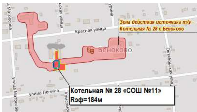
Рис. 2.24. Существующая зона действия системы теплоснабжения и источника тепловой энергии – котельной №28 «СОШ №11»
