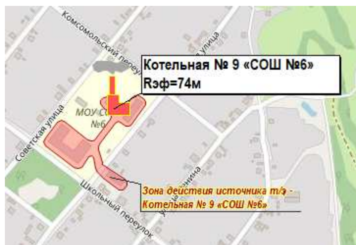
Рис. 2.11. Существующая зона действия системы теплоснабжения и источника тепловой энергии – котельной №9 «СОШ №6»
