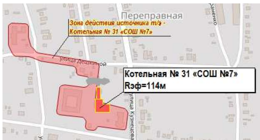
Рис. 2.26. Существующая зона действия системы теплоснабжения и источника тепловой энергии – котельной №31 «СОШ №7»
