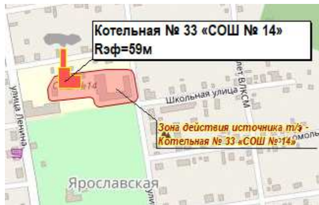
Рис. 2.28. Существующая зона действия системы теплоснабжения и источника тепловой энергии – котельной №33 «СОШ №14»
