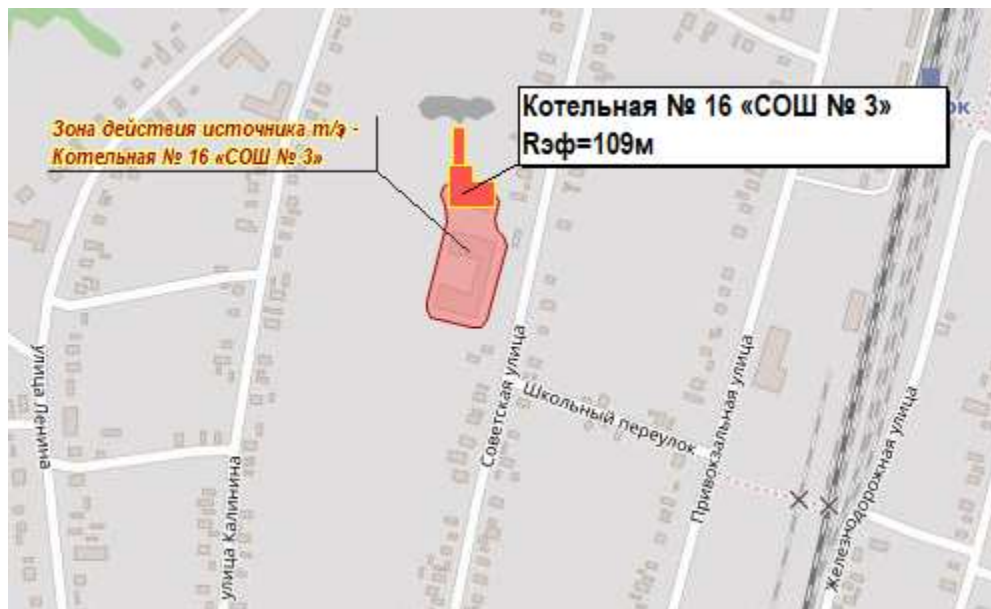
Рис. 2.17. Существующая зона действия системы теплоснабжения и источника тепловой энергии – котельной №16 «СОШ №3»
